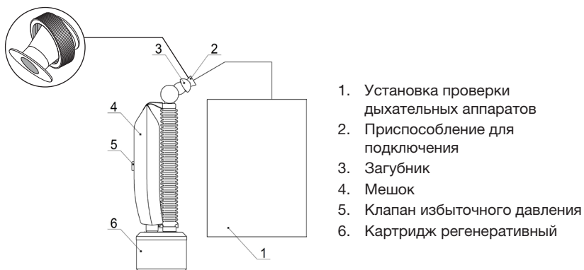
Рис. 4 – Схема проверки герметичности воздуховодной системы
